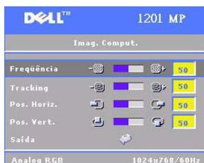
**FREQÜÊNCIA**—Altere a frequência da exibição do relógio de dados para corresponder à frequência da placa gráfica do computador. Se aparecer uma barra vertical tremeluzente, use o controle Frequência para minimizar as barras. Esse é um ajuste primário.
