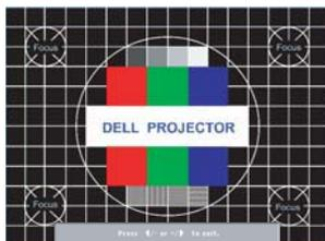
Pressione o botão  $\odot$  no painel de controle ou o botão Menu no controle remoto para exibir o gráfico do modelo de teste. Use essa função para ajustar o foco da tela projetada. Use os botões  $-$  ou  $+$  no painel de controle ou os botões  $\blacktriangleleft$  ou  $\blacktriangleright$  no controle remoto para sair desse modo.
