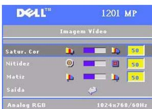
**SATUR COR**—Pressione o botão  $\ominus$  no painel de controle ou o botão  $\blacktriangleleft$  no controle remoto para reduzir a quantidade de cor na imagem; pressione o botão  $\oplus$  no painel de controle ou o botão  $\blacktriangleright$  no controle remoto para aumentá-la.
